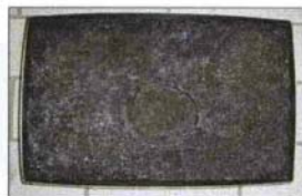
Figura 4 - La piastra confezionata con compattatore a rullo pneumatico, trattata e carotata
