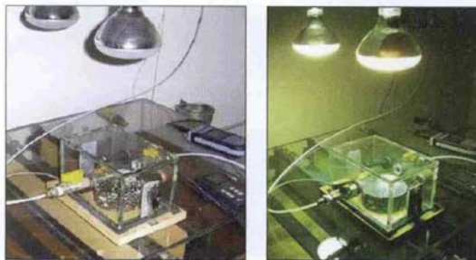
Figure 7A e 7B - L'esecuzione di prova di laboratorio per la determinazione della capacità fotocatalitica
