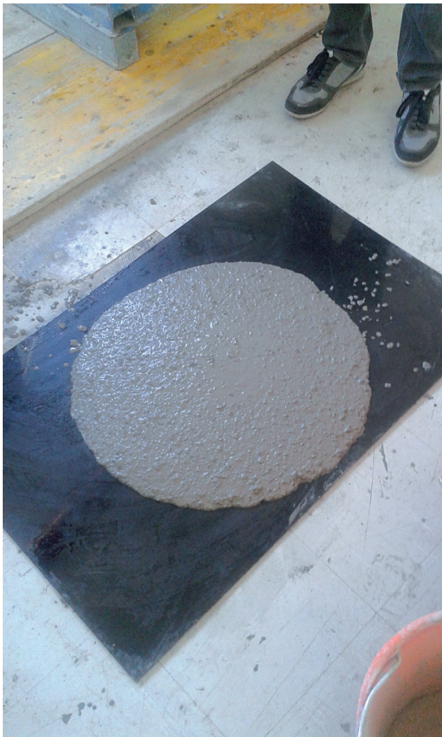
Fig. 1 – Spandimento del calcestruzzo autocompattante Uni En 12350-8 e prova L-Box Uni En 12350-10
