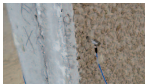
Figura 3: posizionamento dei due accelerometri.
